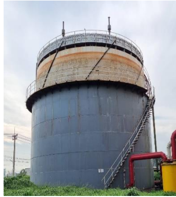
รูปที่ 2-2 ระบบ Biogas เพื่อขจัดปัญหาด้านกลิ่นรบกวน (โรงงานผลิตกรดซิตริก)
